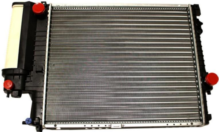
**Kühler Wasserkühler Motorkühler
